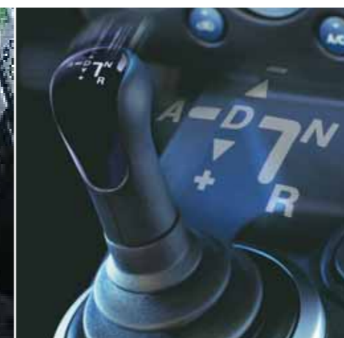
Коробка передач Durashift EST, предлагаемая в качестве опции, представляет последнее поколение механических коробок. Этот 5-ступенчатый агрегат позволяет выбрать между автоматическим режимом и невероятно легким и удобным ручным.
