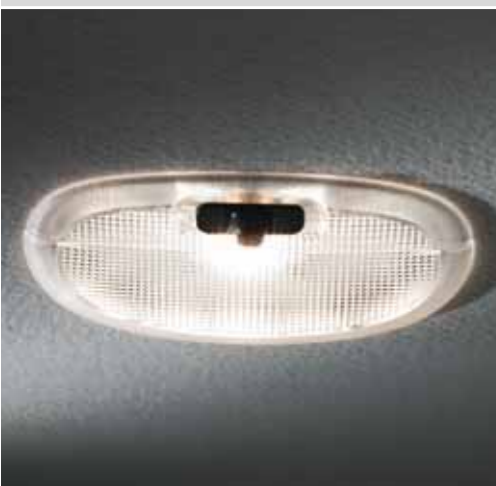
Задний плафон освещения салона Освещение зоны заднего сиденья обеспечивает встроенный центральный плафон.
